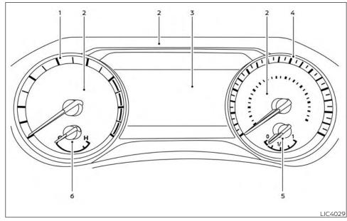
SPEEDOMETER AND ODOMETER
