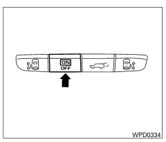
USING THE MAIN ON/OFF SWITCH FOR THE POWER SLIDING DOOR (if so equipped)
